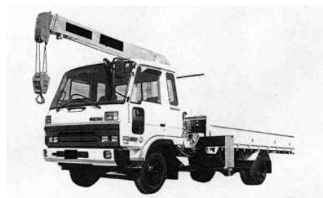
移動式クレーン
