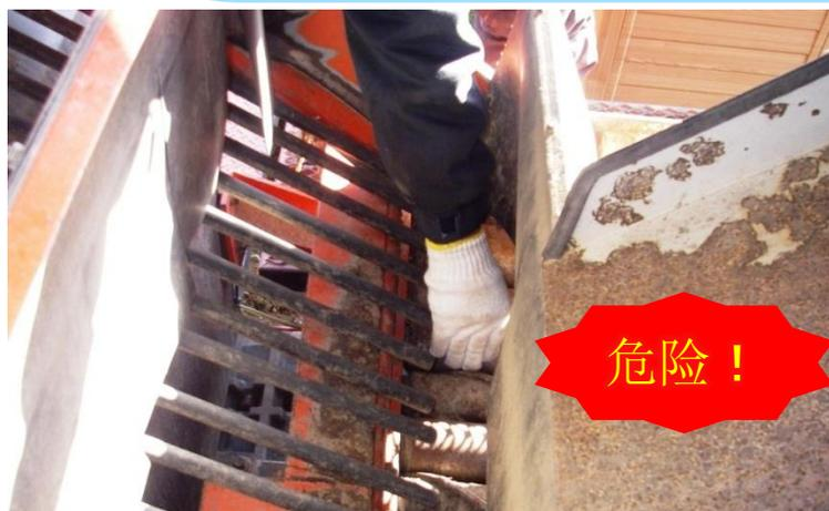
使用马铃薯挖掘机收割马铃薯作业中，正要清除缠在滚轮上的草时，左臂被卷入机械。
