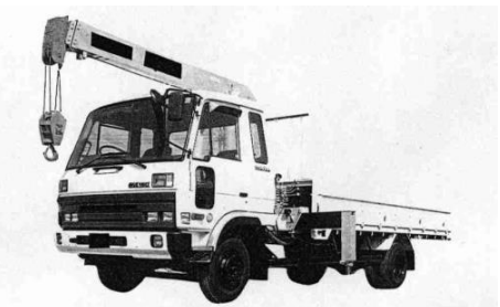
移動式クレーン
