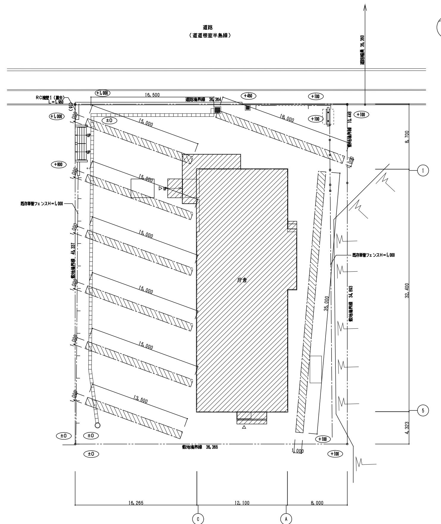
\*建物解体後、巾1.0m程度、深さ1.0mを掘削し、地中埋設物の有無を確認後、掘削部全体を写真撮影し、監督職員に報告する。
