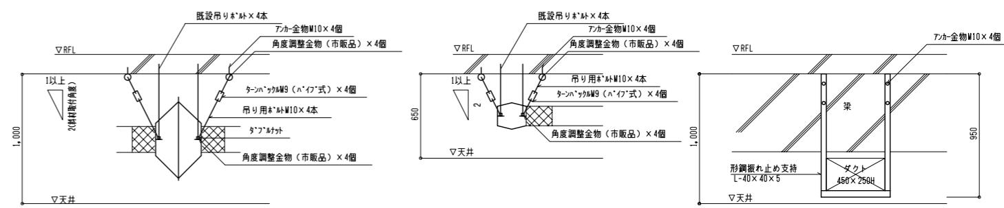
振れ止め支持金具断面図 S-1/20
