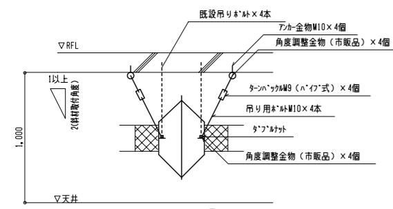
振れ止め支持金具断面図 S-1/20
