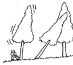
(図4) かかり木に激突させるためにかかり木以外の立木の伐倒
