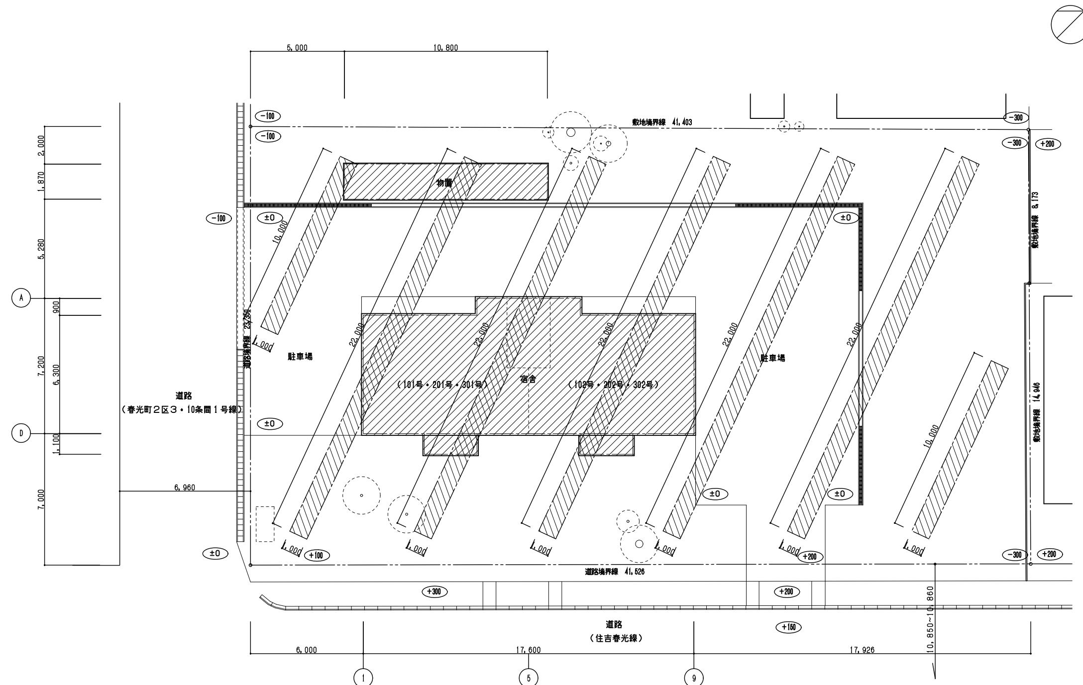
\*建物解体後、巾1.0m程度、深さ1.0mを掘削し、地中埋設物の有無を確認後、掘削部全体を写真撮影し、監督職員に報告する。
