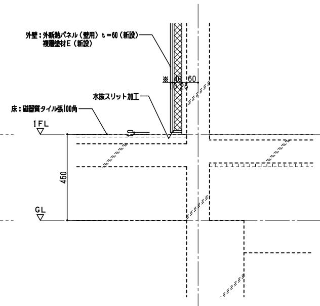
**DT-5 外壁下り壁断熱パネル詳細図** S=1:10
