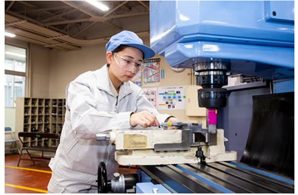
フライス盤作業
