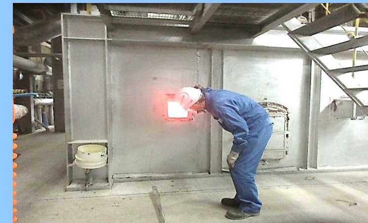
焼却炉視認 (よく燃えてるか?)
