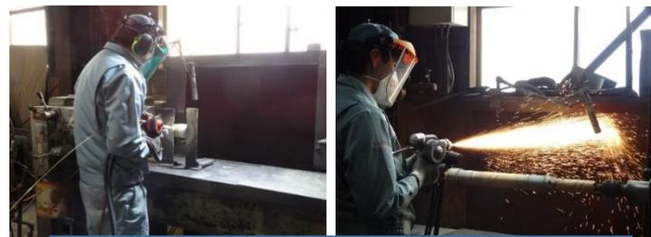
溶射はワイヤー製の素材を高温で溶かし、本体に吹き付けます。
