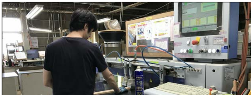
ダボ(木材を接合する時に使用する木製の棒)を打ち込む機械
