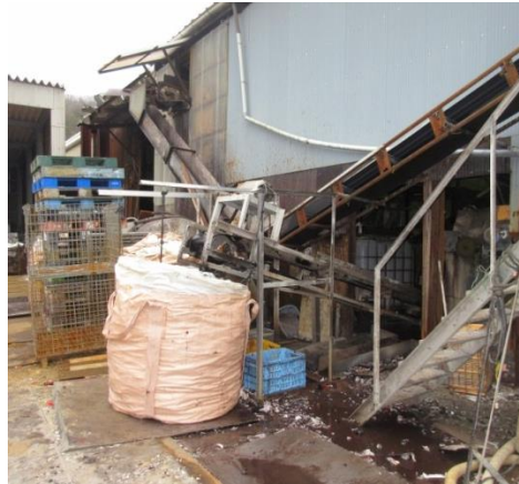
プラスチック部分はベルトコンベアで工場外へ運ばれ、袋詰めされます
