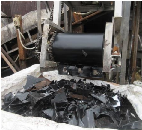
プラスチック部分はベルトコンベアで工場外へ運ばれ、袋詰めされます
