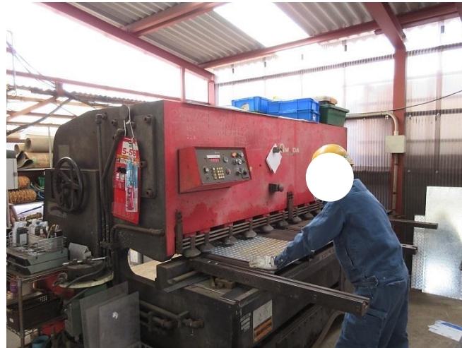
シャーリング（鉄板切断）
