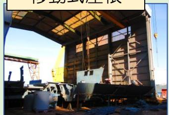
進水式が終了後、艤装と言われる原動機や室内外の各種装備などを船体に取り付ける工程を経て完成し船主に引き渡されます。
