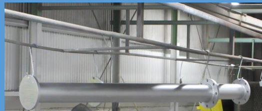
塗装作業：大きな部品は吊り下げた状態で塗装します
