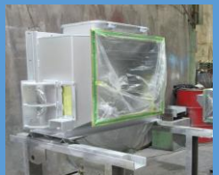
塗装作業：大きな部品は吊り下げた状態で塗装します
