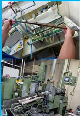
めっき加工・・・ダイヤモンドを付着させる工程。ニッケルメッキ液に工具を浸し、電流を流すことでダイヤモンド粒子を金属表面に付着します。
