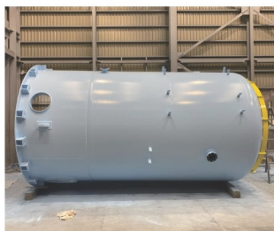
圧力容器（内面ゴムライニング）
