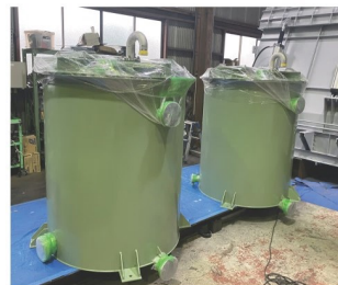
薬品貯槽（内面ゴムライニング）
