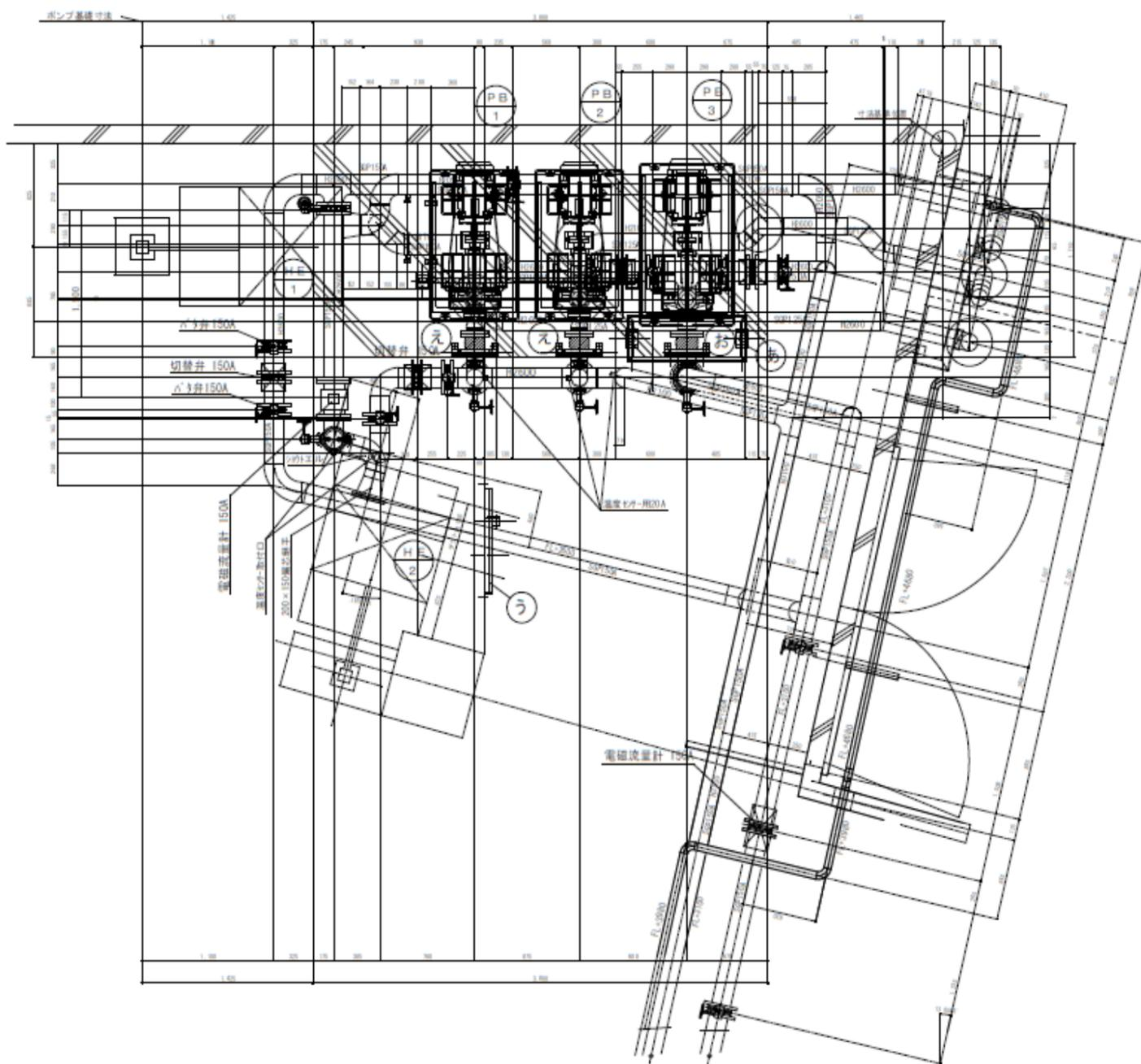
撤去配管部分の支持金物、ブラケットは基本的に既設金物を再用とする。
