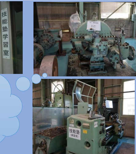
API610に準拠した 垂直割り多段式 二重ケーシング両持ポンプ
