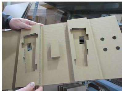
箱の素材は、木や強化段ボールです。梱包する機器に合わせた形状のサイズ、仕切りを設計し組み立てます。
