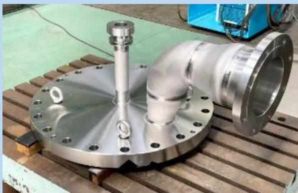
LNG船や陸上プラントに設置されるLNGポンプの付属配管及びカバーを製造しています。
