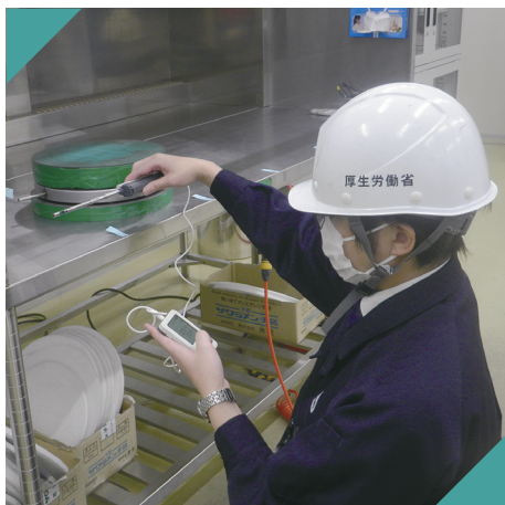
▲ 風速計を用いた局所排気装置の風速の測定
