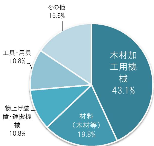
図-5 木材木製品製造業での起因物別労働災害発生状況
