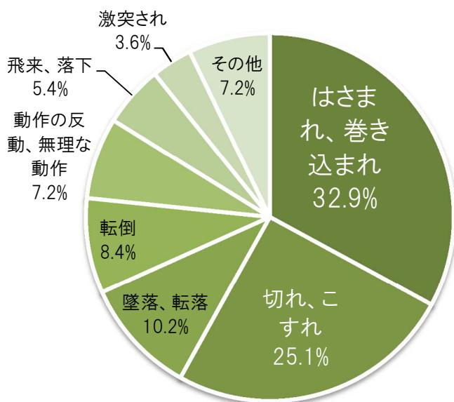
図-4 木材木製品製造業での事故の型別労働災害発生状況
