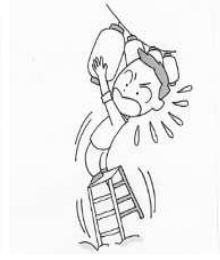
脚立の天板上に乗りバランスを崩す
