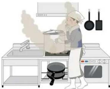
被災者2名でスープや加熱調理の為の作業を行っていたが、換気装置を稼働させていなかった。ガスコンロの径に対し直径の大きな寸胴鍋を乗せて調理作業を行っていたところ、被災者2名ともにCO中毒となった。
