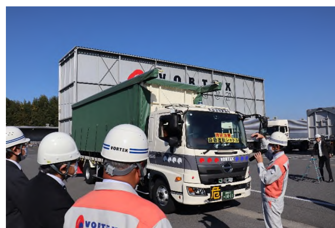
完全無人トラックによる自動搬送システムの実演
