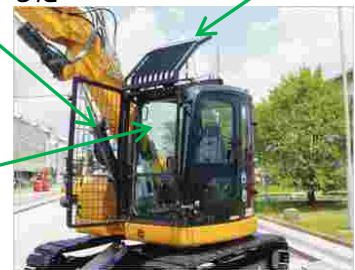
運転室周りの飛来物防護設備の例
