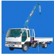
小型移動式クレーン
