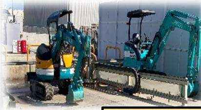
自動洗浄：左右から強い水圧で汚れを落とします
