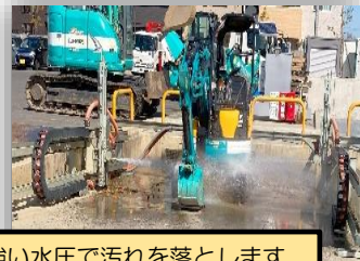
自動洗浄：左右から強い水圧で汚れを落とします
