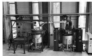
自己治癒材料Basilisk HA 生産設備
