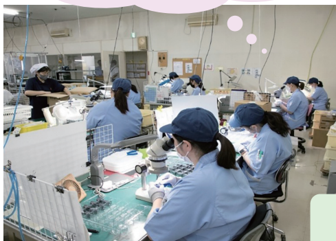
半導体素子の組付け作業 を行っています
