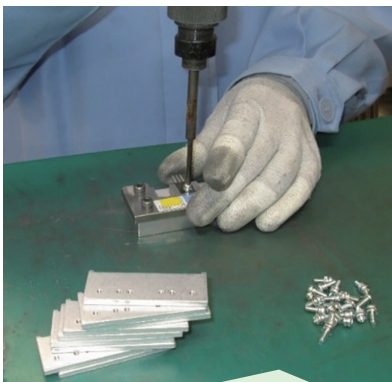
半導体素子の組付け作業 を行っています
