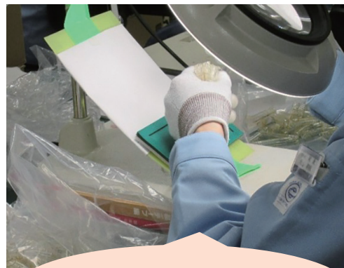
拡大鏡を使用した外観検査の 様子です
