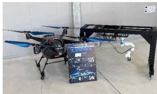
空飛ぶコンクリート3Dプリンター「F3DP」
