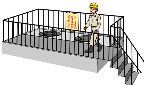
排水処理槽点検作業通路に手すりを取り付けさらにマンホールの蓋は作業終了後確実に閉めるように作業後は必ず閉める」という表示を掲示した。
