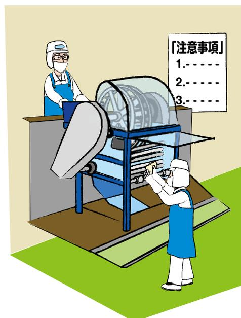
ローラにはカバーを取付け、誤って起動ボタンに触れても、カバーを開けると機械が停止する安全装置を設けた。
