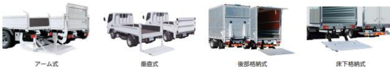
メーカー固有の商品名にかかわらず、労働安全衛生規則においては、貨物自動車の荷台の後部に設置された動力により駆動されるリフトが規制の対象になります。
