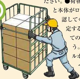
移動時はサイドバーを装着してください。●解除したサイドバーは、接触しないよう積載面側に収納してください。●サイドバーの装着・解除をしやすくするため、ピン穴の塗装のはがれ、サビは取り除いてください。
