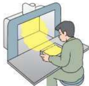
換気装置等を 設置し稼働
