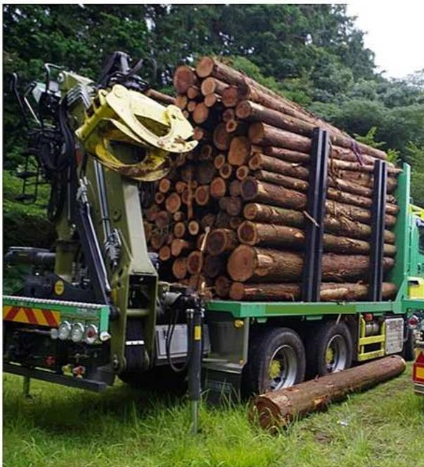
被災者は積載型トラッククレーンの荷台に積載されていた丸太を地面に積み下ろすため、荷台の丸太を縛っていたロープを荷締め機で緩めた際に荷台の支柱（荷台からの高さ370 cm）より高く積載されていた丸太（直径約35 cm、長さ約380 cm、重量約365 kg（推定））が被災者の上半身に落下した
