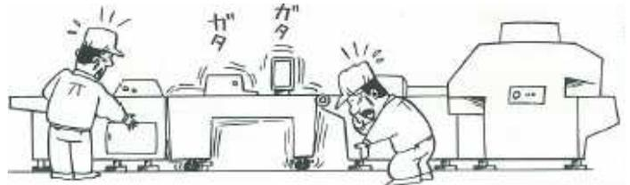
機械重量及び運転時の荷重を考慮し、強固な基礎の上に据付
