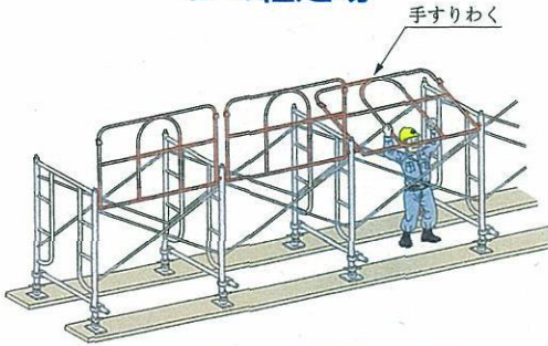
据置手すり機材の取付け
