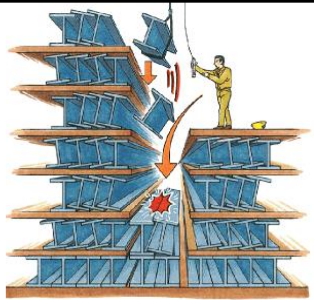
H鋼が落下し下敷き
