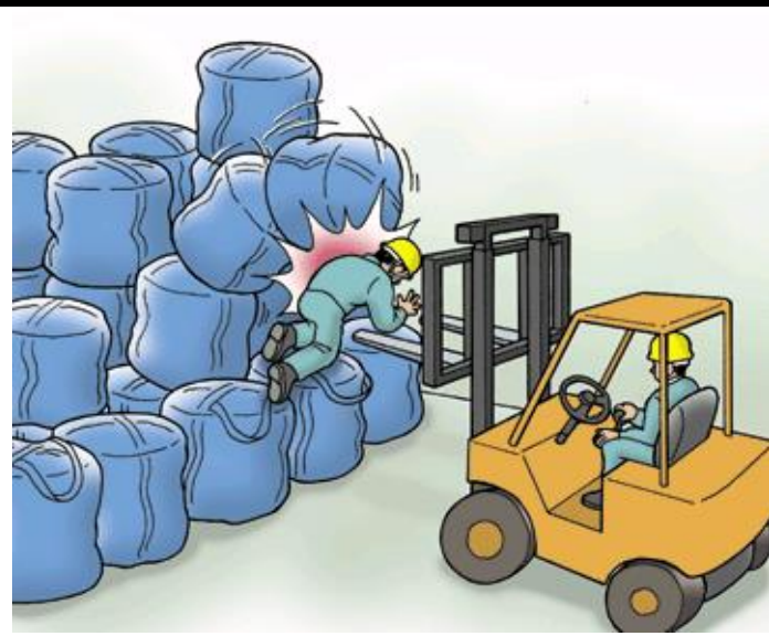
フレコンが崩壊
