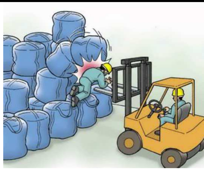
フレコンが崩壊
