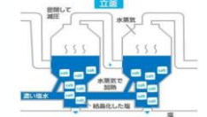
【立釜】※複数の釜を連結して排熱再利用
