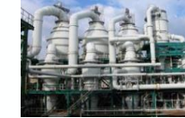
【立釜】※複数の釜を連結して排熱再利用
