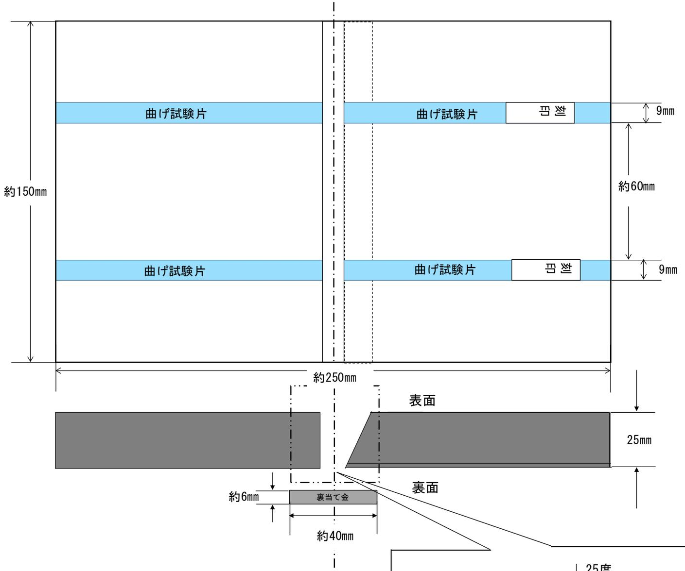
溶接方法は、**下向き突合溶接**とする。
