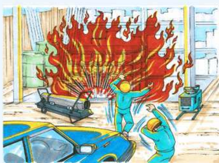
産業廃棄物の廃液を入れたドラム缶から内容物が噴出して、焼却炉の火が引火して爆発的な燃焼を生じた
