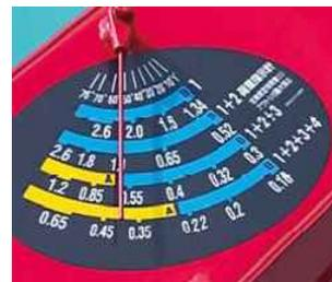
**転倒モーメント**(つり荷の荷重)は、操作レバーの奥、荷台の前に設置されている油圧ゲージを読む。
