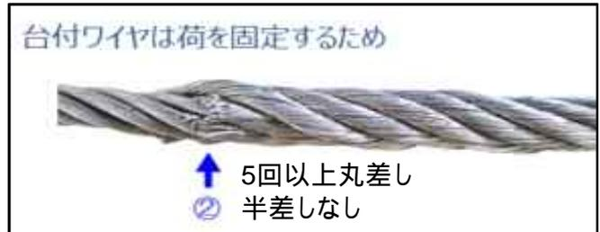
玉掛け用ワイヤロープは、荷や物を吊り上げるためのもので安全率が6以上です。一方台付け用ワイヤロープは荷や物を固定するためのもので安全率は4以上です。それぞれ編み方が異なるため、見分けが付きやすいものですが、玉掛け用に台付け用を使用したことによる事故も発生しています。以下は、平成時代の高額賠償事件の一例です。
