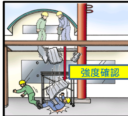
解体中コンクリート床と墜落
