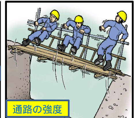
架設通路倒壊し3人墜落
