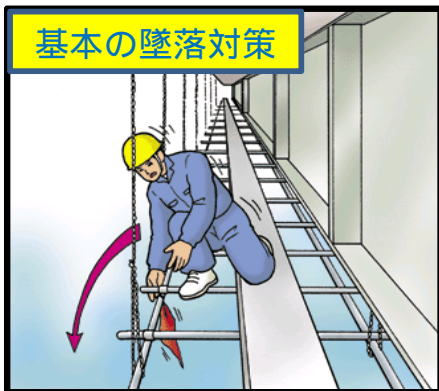
つり足場を移動中墜落
