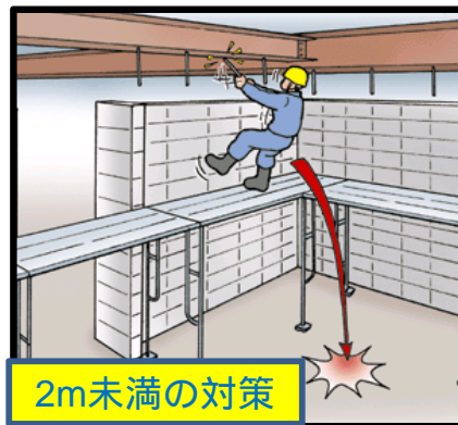
内部足場から墜落
