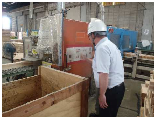
扉の開閉のインターロック機構（扉を開けたら、機械が停止する機構）を確認する委員
