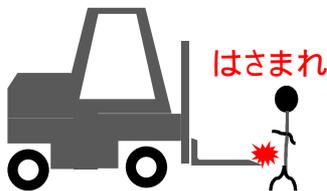
フレコンバックをフォークリフトで所定の場所へ移動させるため、フレコンバックの吊りベルトにフォークリフトの爪を引っ掛ける作業を行っていたところ、フォークリフトが前進した際、作業を手伝っていた被災者がフォークリフトの爪と後部に置いていた物との間に挟まれ死亡した。(鉄鋼業、60歳代、男性)
