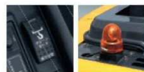
クレーンスイッチ 外部表示灯
